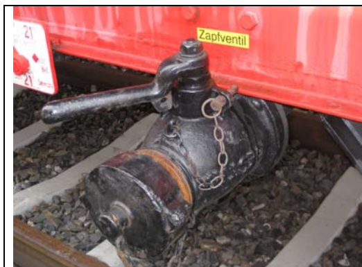
Zapfventil mit Eisenbahn-Kesselwagengewinde
